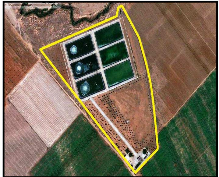
**Figure N°11 : La station de lagunage aéré de GHRISS**
